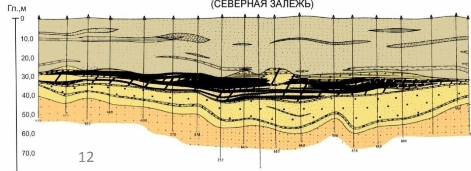
ГЕОЛОГО-ЛИТОЛОГИЧЕСКИЙ РАЗРЕЗ ЖИТКОВИЧСКОГО МЕСТОРОЖДЕНИЯ УГЛЕЙ (СЕВЕРНАЯ ЗАЛЕЖЬ)
